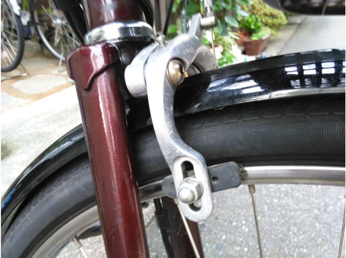
ブレーキブロックが斜めになってタイヤを擦っています
